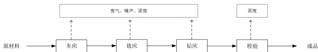
图 5-2 项目工艺流程及产污节点图 (汽车机电设备及零部件加工-线机械零部件加工)
